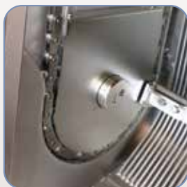
Untere Kettenführung oder unteres Kettenrad
