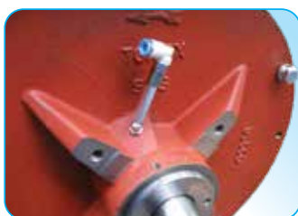
Luftgespülte Dichtungen
