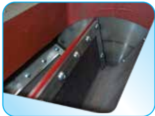
Rotor mit Schleissleisten
